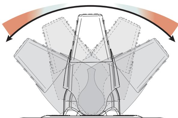
La puissance des propulseurs à commande proportionnelle dépend de la position du joystick/de l'accélérateur.
